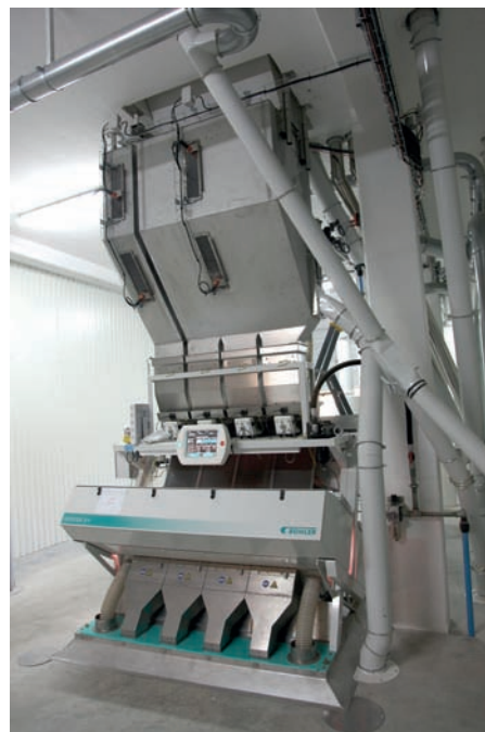
Trieur optique pour contrôler la taille, la forme et la couleur du blé
